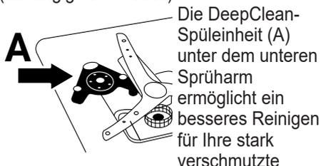
Die DeepClean-Spüleinheit (A) unter dem unteren Sprüharm ermöglicht ein besseres Reinigen für Ihre stark verschmutzte
