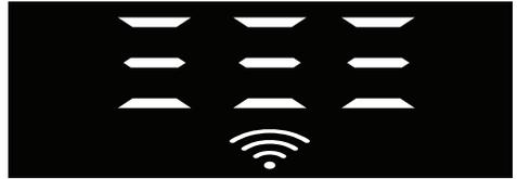
Wenn die drahtlose Verbindung aktiviert ist, leuchtet die WLAN-Verbindungsanzeige ständig. Wenn die drahtlose Verbindung deaktiviert ist, blinkt die WLAN-Verbindungsanzeige in kurzen Abständen. Wenn Sie die Fernbedienungstaste drücken, während die Funktion aktiviert ist, die HomeWhiz-Funktion deaktiviert ist, wechselt die Produkthanzeige in die Anzeige der Verzögerungszeit/Programmzeit. In der Aus-Position wird die LED der HomeWhiz-Taste ausgeschaltet.
