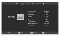
3 Use »V« or »∧« to select »Picture Mode«, »Contrast«, »Brightness«, »Colour«, »Sharpness«, »Colour Temp« or »Noise Reduction«.
