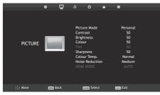
3 Use »V« or »∧« to select »Picture Mode«, »Contrast«, »Brightness«, »Colour«, »Sharpness«, »Colour Temp« or »Noise Reduction«. Select the value using »<« or »>« and confirm your selection with »●«.
