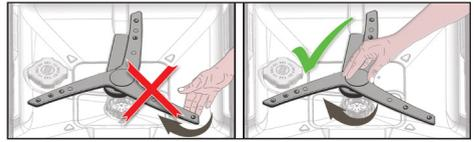
**i** Versuchen Sie nicht, den Sprüharm durch Druck auf seine Enden zu drehen. Durch den Versuch, die Endabschnitte zu drehen, könnte das Getriebesystem im Sprüharm brechen.
