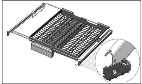
Wenn sich die mittlere Ablage in der unteren Position befindet, können Sie Gegenstände wie Espressotassen, Löffel usw. darauf ablegen. Wenn die seitlichen Ablagen nach außen geschoben sind, kann die zentrale Ablage durch Ziehen des Hebels angehoben werden, woraufhin das System verriegelt wird.
