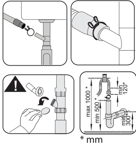
**i** Der Wasserablauf sollte direkt in die Kanalisation führen; das Abwasser darf nicht in das Oberflächen- oder Grundwasser gelangen.
