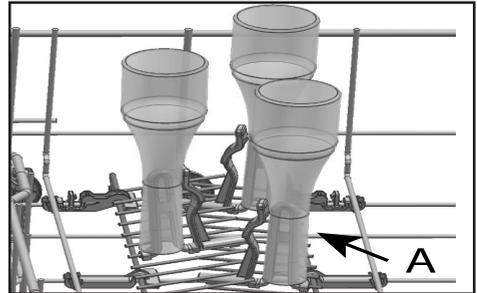
Und wenn Sie den faltbaren Draht in die vertikale Position bringen, können Sie Ihr Geschirr platzieren, ohne die Halter zu entfernen.
