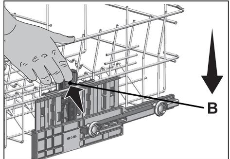
**i** Der Bewegungsmechanismus funktioniert möglicherweise nicht richtig, wenn der obere Korb überladen oder das Gewicht ungleichmäßig verteilt ist. Bei übermäßigem Gewicht könnte der Korb herunterfallen.
