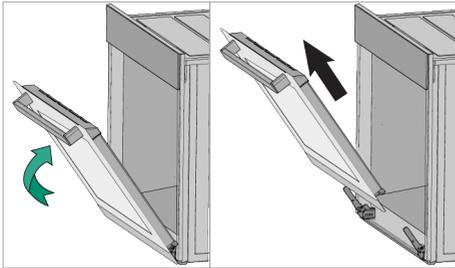
8. Ziehen Sie die entfernte Tür nach oben, um sie aus dem rechten und linken Scharnier zu lösen und zu entfernen.
