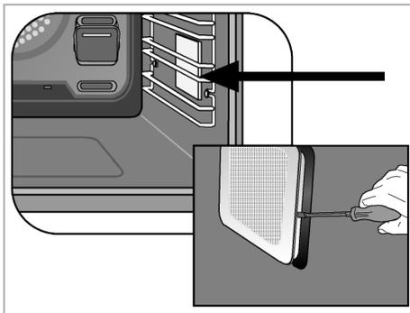
3. Heben Sie die Glasabdeckung des Leuchtmittels mit einem Schraubendreher an. Entfernen Sie zuerst die Schraube, wenn in Ihrem Produkt eine Schraube an der quadratischen Lampe vorhanden ist.
