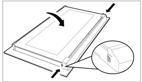
2. Ziehen Sie das am Oberteil der Vordertür befestigte Kunststoffteil zu sich, indem Sie gleichzeitig auf die Druckpunkte auf beiden Seiten des Bauteils drücken und entfernen Sie es.
