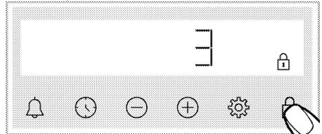
» Das symbol 🔒 erscheint und der Countdown 3-2-1 beginnt auf der Anzeige. Wenn der Countdown abgelaufen ist, wird die Tasten sperre aktiviert. Wenn bei eingestellter Tasten sperre eine beliebige Taste berührt wird, ertönt ein akustisches Signal und das symbol 🔒 blinkt.
