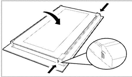
2. Ziehen Sie das oben auf die Vordertür montierte Kunststoffteil zu sich, indem Sie auf die Druckpunkte auf beiden Seiten des Kunststoffteils drücken und entfernen Sie das Kunststoffteil.
