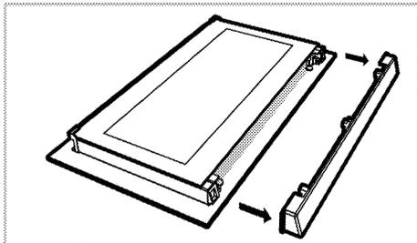
3. Entfernen Sie, wie in der Abbildung gezeigt, das innerste Glas, indem Sie es leicht in Richtung 'A' anheben und in Richtung 'B' herausziehen.
