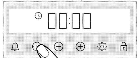
**i** Nach der Einstellung der Betriebsfunktion und der Temperatur können Sie durch direktes Berühren der Taste die Garzeit für 30 Minuten einstellen und mit den Tasten / die Zeit ändern.
