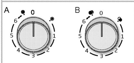
Ihr Gerät ist möglicherweise mit Zonen vom Typ A oder B ausgestattet. Mehrere Kochzonen ermöglichen das Kochen mit Töpfen mit unterschiedlichen Durchmessern in derselben Zone. Wenn diese Zonen zum ersten Mal eingeschaltet werden, wird die Zone in der Mitte eingeschaltet. (Der schattierte Bereich in der Abbildung sind zentrale Zonen.)
