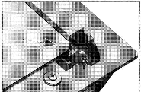
Der erste Schritt zum Umgruppieren der Tür besteht darin, das zweite und dritte innere Glas (2, 3) an sein Platz einzusetzen.
