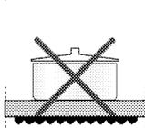
Wenn der Topfdurchmesser zu klein ist, wird Energie verschwendet.
