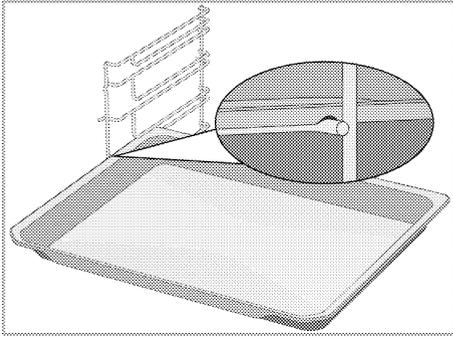
**Richtige Platzierung des Rostes und des Backblechs auf den Teleskopschienen Modelle mit Drahtfachböden und Teleskopschienen**
