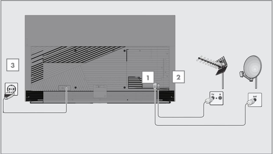
**1** Für den Empfang von digitalen Satellitensendern (DVB-S) stecken Sie das Satellitenantennenkabel in die Antennenbuchse »**SATELLITE**« am Fernsehgerät;
