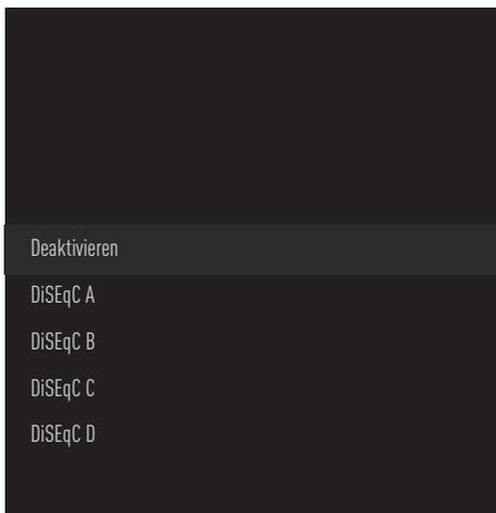
Wählen Sie »DiSEqC A«, »DiSEqC B«, »DiSEqC C« oder »DiSEqC D«, um den Satelliten auszuwählen, der den jeweiligen DiSEqC-Positionen im Satellitensystem entspricht.
