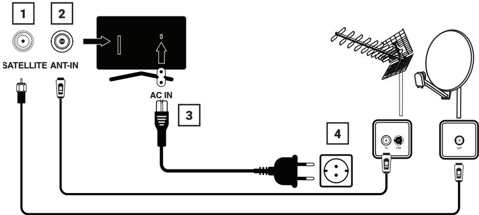
**1** Schließen Sie bei digitalen Satellitensendern (DVB-S/S2) das Kabel der Satellitenantenne an den Antennenanschluss **SATELLITE** am Fernseher an:
