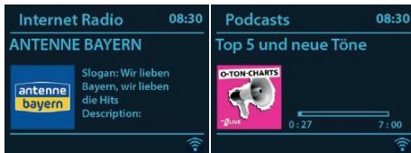
L'appareil peut jouer des milliers de stations de radio et des podcasts du monde entier grâce à une connexion Internet à haut débit. Lorsque vous sélectionnez la radio Internet ou le mode Podcasts, l'appareil contacte directement le portail Frontier Smart Technologies pour obtenir une liste des stations ou des podcasts.
