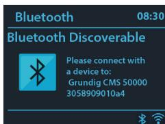
En mode Bluetooth, vous pouvez activer le Bluetooth de votre appareil Bluetooth. Appuyez et maintenez »**BT PAIR**« afin de rendre le Bluetooth détectable. Depuis votre appareil Bluetooth, recherchez le système HiFi Grundig DTR 7000 jusqu'à l'appairage. Lorsqu'il est en attente d'appariement, il y a une icône Bluetooth clignotante en bas. Si l'appariement a réussi, l'icône Bluetooth devient fixe. Contrôlez la lecture de la musique à partir de votre appareil Bluetooth.
