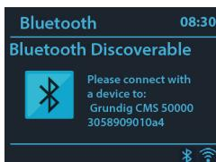
Im Bluetooth-Modus können Sie die Bluetooth-Funktion Ihres Bluetooth-Geräts einschalten. Halten Sie »**BTPAIR**« gedrückt, damit das Gerät per Bluetooth auffindbar wird. Suchen Sie über Ihr Bluetooth-Gerät zur Kopplung nach dem HiFi-System Grundig DTR 7000. Während es auf Kopplung wartet, blinkt ein Bluetooth-Symbol im unteren Bereich. Bei erfolgreicher Kopplung leuchtet das Bluetooth-Symbol dauerhaft. Steuern Sie die Musikwiedergabe über Ihr Bluetooth-Gerät.
