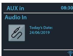
Im AUX-Eingangsmodus wird Audio von einer externen Quelle wiedergegeben. Verringern Sie die Lautstärke sowohl am Radio als auch am Audioeingangsgerät (falls möglich). Rufen Sie den AUX-Modus auf und passen Sie die Lautstärke wie erforderlich an.
