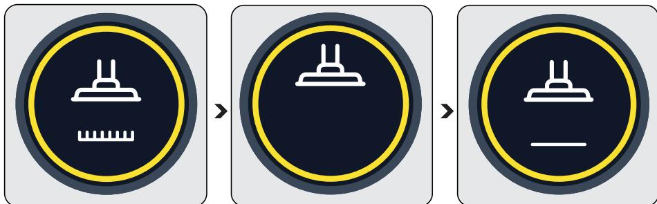
Lorsque la brosse de détection automatique de sol (brosse turbo motorisée) (8) passe d'une moquette à un sol dur, les pictogrammes ci-dessus s'affichent sur l'écran principal LCD (4).
