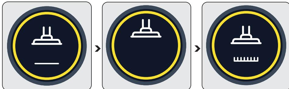
Når den automatiske gulvdetektsjonsbørsten (8) beveger seg fra et hard gulv til et teppegulv, skal figurene vist ovenfor animeres på skjermen (4).
