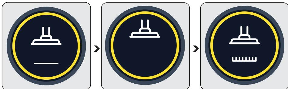
Lorsque la brosse de détection automatique de sol (brosse turbo motorisée) (8) passe d'un sol dur à une moquette, les pictogrammes ci-dessus s'affichent sur l'écran principal LCD (4).
