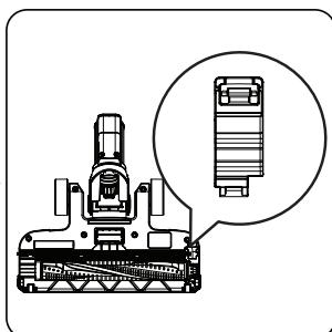
Pour retirer la turbo-brosse électrique (10), déverrouillez-la à l'aide de la languette de retrait de la brosse cylindrique et retirez le couvercle.
