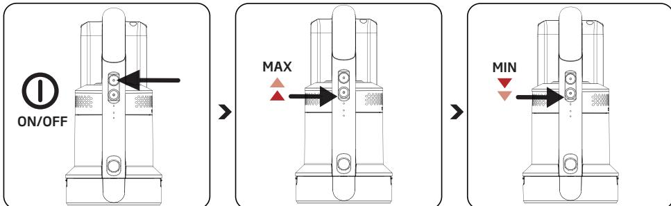
Drücken Sie die Ein-/Aus-Taste **A**, um das Gerät zu bedienen. Das Gerät beginnt mit der mittleren Geschwindigkeit zu laufen, wenn die Ein-/Aus-Taste gedrückt wird.
