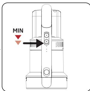
Jednom pritisnite gumb načina rada **B** za rad uređaja na minimalnoj brzini.
