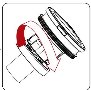
Drehen Sie den Zyklonkegel in Pfeilrichtung und setzen Sie ihn wieder ein.
