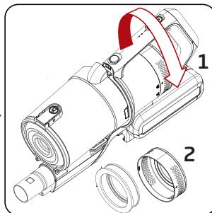
Retirez le couvercle du filtre D'échappement en le tournant dans le sens de la flèche.
