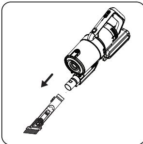
Bringen Sie die Fugendüse **L** an das Ende des Gehäuses an. Um die Fugendüse zu entfernen, drücken Sie die Entriegelungstaste.
