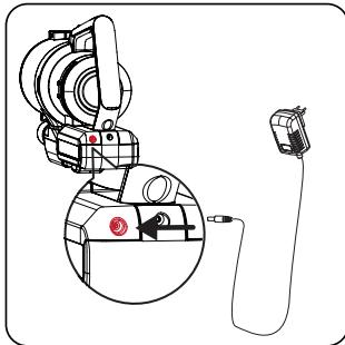
Stecken Sie ein Ende des Adapters **K** in die Steckdose und das andere Ende in den Ladeschacht, der ebenfalls ein Gehäuse hat. Ladezustandsanzeigen **D** am Gehäuse blinken während des Ladevorgangs. Alle Anzeigen erlöschen, wenn der Ladevorgang abgeschlossen ist.
