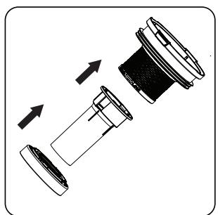
Nach dem Trocknen den Zyklonkegel in Pfeilrichtung schieben und zusammenstecken.
