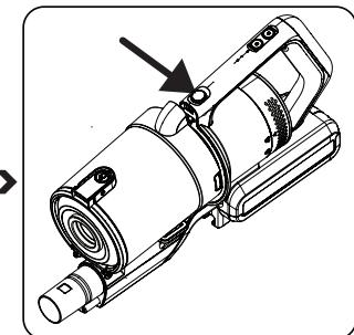
Para limpiar el cono ciclónico del depósito de polvo, pulse el botón de extracción del depósito de polvo **E**.
