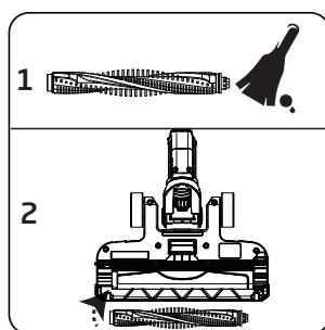
Za uklanjanje prašine s njega, lagano udrite njime po tvrdoj površini kako bi se prašina istresla sa četke. Ili, uklonite prašinu pomoću četke.
