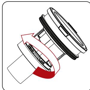
Entfernen Sie den Zyklonkegel, indem Sie ihn in Pfeilrichtung drehen und entfernen Sie den Staub darin.
