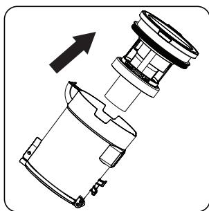
Retirez le cône cyclone du réservoir à poussière.
