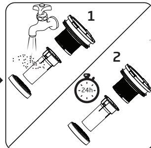
Nach dem Waschen unter fließendem Wasser mindestens 24 Stunden trocknen lassen.
