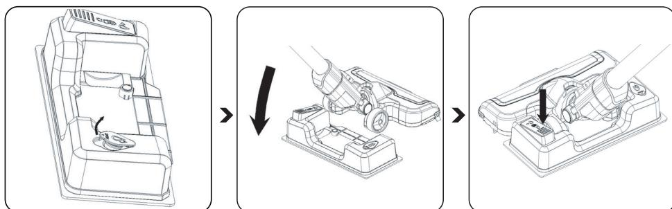
Ouvrez le couvercle du réservoir d'eau **N** dans le sens de la flèche, remplissez le réservoir d'eau à l'aide d'un verre ou d'un robinet.
