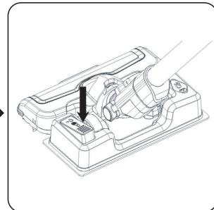
Åpne vanntankdekselet **N** i pilens retning, fyll vanntanken ved hjelp av et glass eller en kran.
