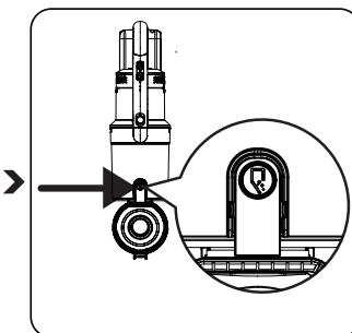
Uklonite metalnu cijev **H** s kućišta.
