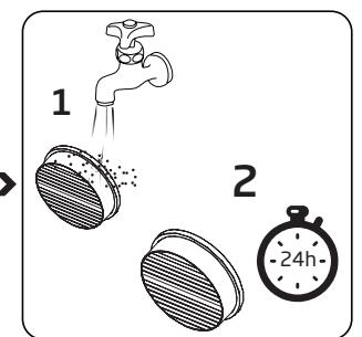
Tvätta motorns insugsfilter under rinnande vatten och låt den torka i 24 timmar, efter att vattnet har kramats ur den.
