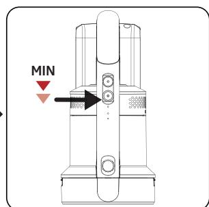
Minimum hızda çalıştmak için mod düğmesine **B** basın.
