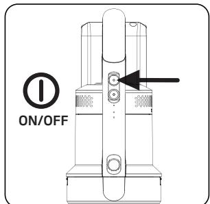
Naciśnij włącznik **A**, aby uruchomić urządzenie. Po naciśnięciu włącznika urządzenie uruchamia się ze średnią prędkością.
