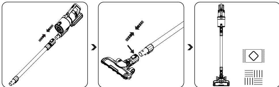
Befestigen Sie das Saugrohr [H]
