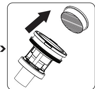
Saque el filtro de entrada del motor de su soporte y retírelo en la dirección de la flecha. Elimine el polvo acumulado en el filtro de entrada del motor antes de lavarlo. Para eliminar el polvo del filtro de entrada del motor, puede verter el polvo golpeándolo suavemente sobre una superficie dura. O bien, puede limpiar el polvo del filtro de entrada del motor con la ayuda de un cepillo.
