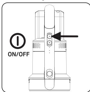
Pritisnite gumb isključeno **A** za rukovanje uređajem. Uredaj počinje s radom sa srednjom brzinom kada se pritisne gumb uključivanja/isključivanja.
