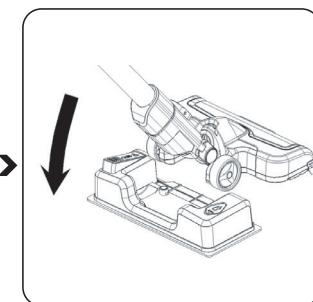
Placer rengöringsduken på plats under golvtsorkningstillbehöret. Placera golvtsorkningstillbehöret på golvet och anslut borsten och apparaten från de magnetiska delarna.
