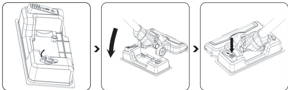
Abra la tapa del depósito de agua **N** en la dirección de la flecha, llene el depósito de agua con la ayuda de un vaso o grifo.
