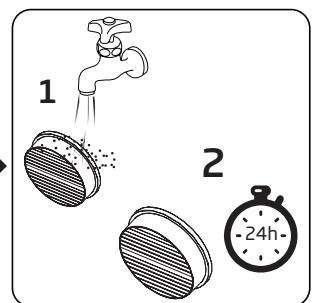
Lave el filtro de entrada del motor bajo el agua corriente y déjelo secar durante 24 horas después de apretarlo suavemente.
