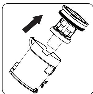
Uklonite cyclone cijev iz spremnika za prašinu.
