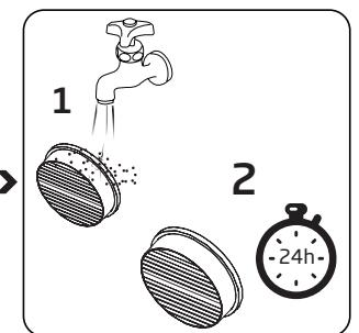
Vask motorinntaksfILTERET under rennende vann og la det tørke i 24 timer etter å ha klemt det forsiktig.
