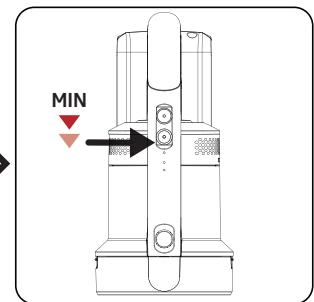
Tryck på lägesknappen **B** en gång, för att använda apparaten på minimihastighet.
