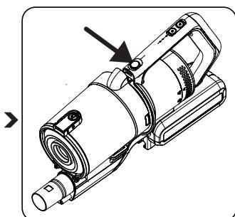
Toz haznesi içindeki siklon koniyi temizlemek için toz haznesi çıkarma düğmesine **E** basın.
