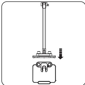
Coloque la estación de carga **Q** en el soporte de la estación de carga **P**.
