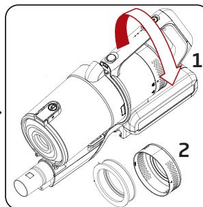
Retire la tapa del filtro Escape girándola en la dirección de la flecha.
