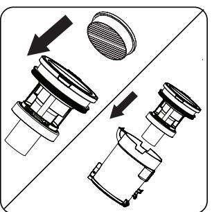
Montieren Sie den Motoreingangsfilter am Zyklonkonus und setzen Sie ihn in den Staubbehälter ein.
