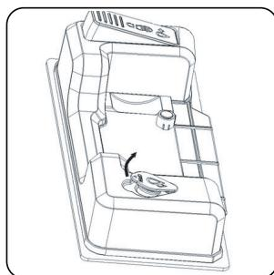
Öppna vattenbehållarens **N** lock i pilens riktning, fyll behållaren med vatten med ett glas eller från kranen.
