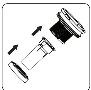
Una vez seco, empuje el cono del ciclón en la dirección de la flecha y fíjelo.
