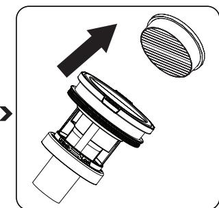
Fjern motorinntaksfILTERET fra holderen og fjern det i pilens retning. Fjern støvet i motorinntaksfILTERET før vask. For å fjerne støv fra motorinntaksfILTEREN, kan du helle støvet ved å slå det forsiktig mot en hard overflate. Du kan også rengjøre støvet fra motorinntaksfILTERET ved hjelp av en børste.
