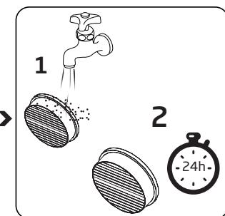
Umyj filtr wlotowy silnika pod bieżącą wodą i pozostaw do wyschnięcia na 24 godziny po delikatnym wycisnięciu.
