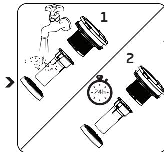
Wyjmij stożek cyklonowy, obracając go w kierunku strzałki i usuń z niego kurz.
