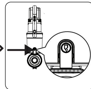
Fjern metalrøret **H** fra kroppen. Tryk på knappen **F** på dækslet på støvbeholderen for at åbne støvbeholderen og tømme den for det støv, der har samlet sig indeni.
