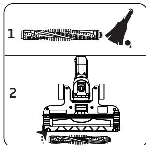
Entfernen Sie den Staub, indem Sie leicht auf eine harte Oberfläche klopfen, oder entfernen Sie den Staub mit einer Bürste. Wenn sich Haare usw. verheddern, entfernen Sie sie, indem Sie sie abschneiden.
