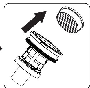
Fjern motorinputfilteret fra dets holder og fjern det i pilens retning. Fjern støvet, der er samlet i motorinputfilteret før vask. For at fjerne støvet fra motorinputfilteret, kan du hælde det ud let, ved at slå den mod en hård overflade. Eller du kan rense støvet fra motorinputfilteret ved hjælp af en børste.
