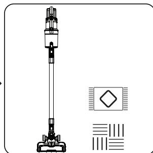
Na kraj kućišta instalirajte cijev **H**. Uklonite ga pritiskom na gumb za odvajanje **G**.
