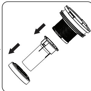
Entfernen Sie das Zyklonrohr und seine Halterung.
