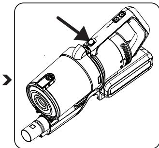
Pour nettoyer le cône cyclone dans le réservoir à poussière, appuyez sur le bouton de retrait du réservoir à poussière **E**.
