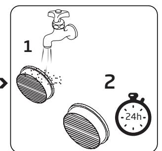
Filtar ulaznog otvora motora operite ispod tekuće vode i ostavite ga neka se suši 24 sata nakon što ste ga lagano ocijedili.
