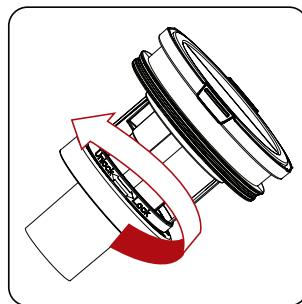
Retire el cono del ciclón girándolo en la dirección de la flecha y elimine el polvo que hay en él.
