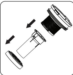
Uklonite cyclone cijev i njen držač.
