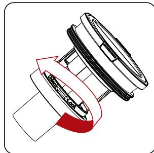
Uklonite cyclone cijev okretanjem u smjeru strelice i uklonite prašinu.
