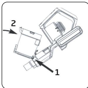
Para fijar el depósito de polvo al cuerpo, coloque la lengüeta de bloqueo del depósito de polvo en la ranura del interior del cuerpo.
