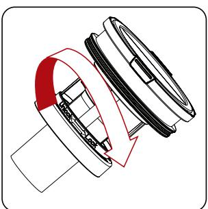
Tournez le cône cyclone dans le sens de la flèche et remettez-le en place.
