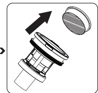
Ta bort motorns insugsfilter från dess hållare i pilens riktning. Ta bort dammet från motorns insugsfilter, innan den tvättas. Du kan ta bort dammet från motorns insugsfilter genom att slå den försiktigt mot en hård yta. Eller rengöra motorns insugsfilter med en borste.
