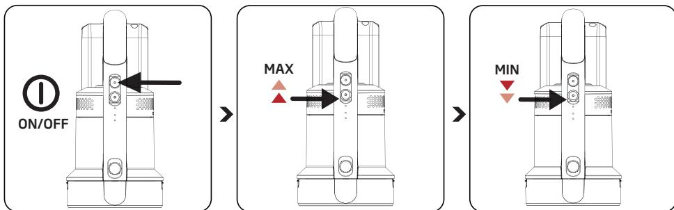
Appuyez sur le bouton marche-arrêt **A** pour faire fonctionner l'appareil. L'appareil fonctionne à vitesse moyenne lorsque vous appuyez sur le bouton Marche/Arrêt.
