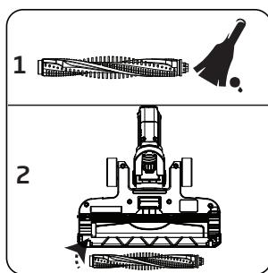
For at rense støvet på den skal du slå den let mod en hård overflade for at få støvet på børsten ud. Eller fjern støvet fra den ved hjælp af en børste.
