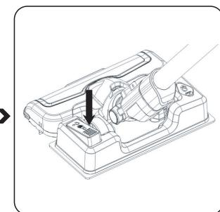
Tryck på vattenpumpen med foten. Rengöringsduken blöts av vattnet som rinner ut från bottnet. Efter att golvtsorkningstillbehöret har använts, ta bort duken, töm vattnet ur behållaren och torka duken.
