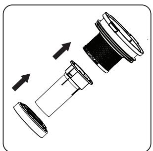
Une fois sec, poussez le cône cyclone dans le sens de la flèche et fixez-le ensemble.
