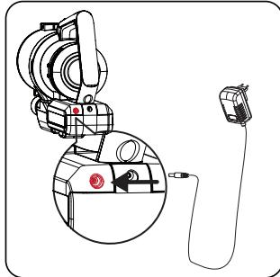
Branchez une extrémité de l'adaptateur **K** dans la prise de courant et l'autre extrémité dans la fente de chargement, qui comporte également un boîtier. Les indicateurs de niveau de charge **D** sur le boîtier clignotent pendant la charge. Tous les indicateurs s'éteignent lorsque la charge est terminée.
