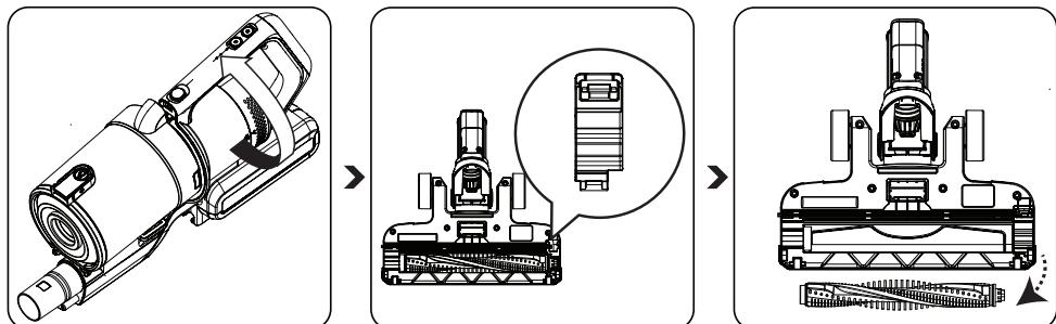
Efter at udstødningsfilter bliver tørt, så sæt det tilbage og indsæt den ved at dreje dækslet i pilens retning.
