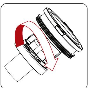
Gire el cono del ciclón en la dirección de la flecha y vuelva a colocarlo.
