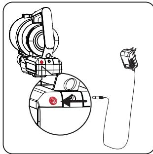
Enchufe un extremo del adaptador **K** en la toma de corriente y el otro extremo en la ranura de carga, que también tiene un cuerpo.
