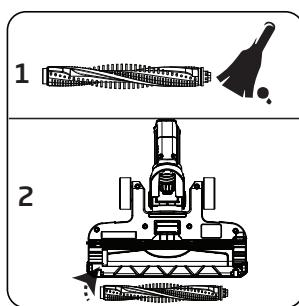
Üzerindeki tozlardan arındırmak için hafifçe sert bir yüzeye vurarak fırça üzerindeki tozların dökülmesini sağlayın. Ya da bir fırça yardımıyla üzerindeki tozlardan arındırın.
