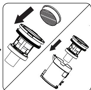
Instalirajte filter ulaznog otvora motora na cyclone cijev i stavite je u spremnik za prašinu.
