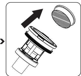
Retirez le filtre d'entrée du moteur de son support et retirez-le dans le sens de la flèche. Retirez la poussière accumulée dans le filtre d'entrée du moteur avant le lavage. Pour enlever la poussière du filtre d'entrée du moteur, vous pouvez verser la poussière en la frappant doucement sur une surface dure. Vous pouvez également nettoyer la poussière du filtre d'entrée du moteur à l'aide d'une brosse.
