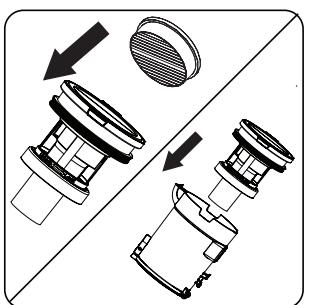
Installez le filtre d'entrée du moteur sur le cône cyclone et placez-le dans le réservoir à poussière.
