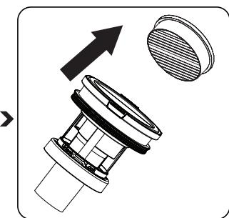
Motor giriş滤resini tutucusundan çekip ok yönünde çıkarın. Motor giriş滤resi içinde biriken tozları yıkama öncesi arındırın. Motor giriş滤resini üzerindeki tozları arındırmak için hafifçe sert bir yüzeye vurularak tozların dökülmesi sağlanabilir. Ya da bir fırça yardımıyla motor giriş滤resi üzerindeki tozlar arındırılabilir.
