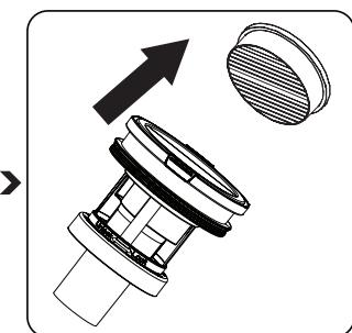
Wyjmij filtr wlotowy silnika z uchwytu i wyjmij go w kierunku strzałki. Przed myciem usuń kurz nagromadzony w filtre wlotowym silnika. Aby usunąć kurz z filtra wlotowego silnika, można go wysypać, delikatnie uderzając filtrem o twardą powierzchnię. Możesz też usunąć kurz z filtra wlotowego silnika za pomocą szczoteczki.
