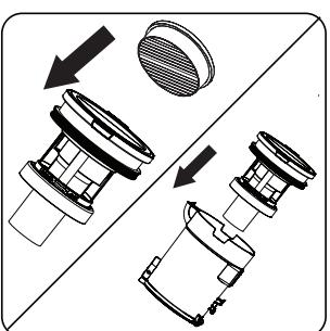
Instale el filtro de entrada del motor en el cono del ciclón y colóquelo en el depósito de polvo.
