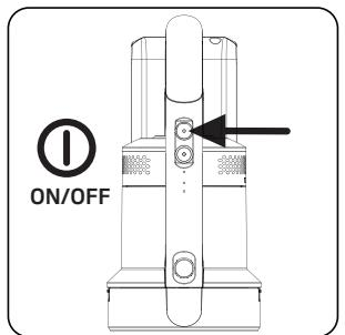
Tryck på/på knappen **A** för att använda apparaten. Apparaten startar på minimihastighet, när på/av-knappen trycks.
