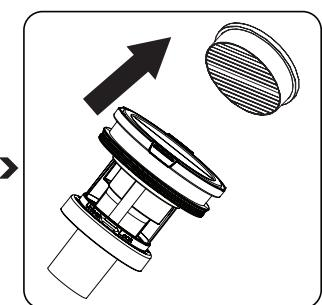
Uklonite filter ulaznog otvora motora s njegovog držača i uklonite ga u smjeru strelice. Uklonite prašinu nakupljenu na filtru ulaznog otvora motora prije pranja. Za uklanjanje prašine s filtra ulaznog otvora motora možete ukloniti prašinu lagani lupkanjem filtra o tvrdou površinu. Ili prašinu s filtra ulaznog otvora motora možete očistiti pomoću četke.
