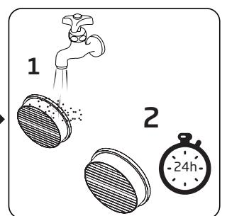
Vask motorinputfilteret under rindende vand og lad det tørre i 24 timer efter at have rystet den let.
