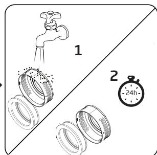
Lagano protresite Ispušni filter i uklonite prašinu, operite ga tekućom vodom i ostavite ga neka se suši barem 24 sata.
