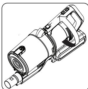
Después de que el filtro Escape se haya secado, vuelva a colocarlo girando la tapa en la dirección de la flecha.
