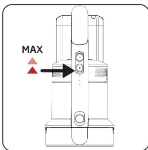
Jednom pritisnite gumb načina rada **B** za rad uređaja na maksimalnoj brzini.
