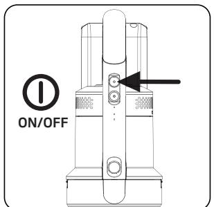
Trykk på på/av-knappen **A** for å kjøre apparatet. Apparatet begynner å kjøre med medium hastighet når du trykker på av/på-knappen.
