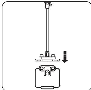
Umieść stację ładowającą **O** na wsporniku stacji ładowającej **P**.
