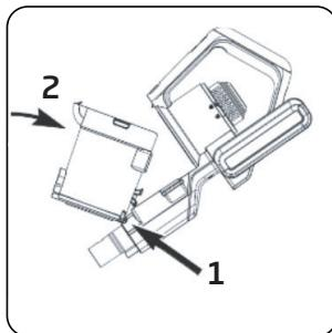
Pour fixer le réservoir à poussière au corps, placez la languette de verrouillage du réservoir à poussière dans la fente située à l'intérieur du corps.
