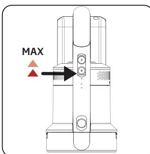
Cihazı maximum hızda çalıştmak için mod düğmesine **B** bir defa basın.
