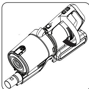
Une fois que le filtre D'échappement est sec, remettez-le en place et insérez-le en tournant le couvercle dans le sens de la flèche.
