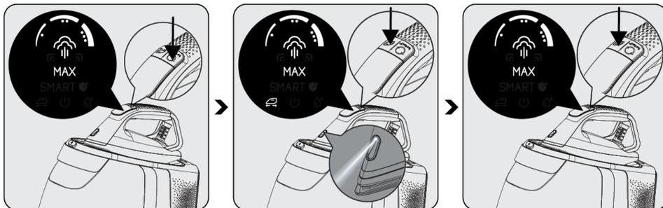
Stellen Sie mit der Dampftaste (3) die für den Stoff geeignete Temperatur und Dampfmenge ein. (siehe 3.6)
