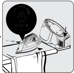
Die Anzeige für die automatische Abschaltung "⏻" erlischt, wenn Sie das Bügeleisen bewegen oder eine Taste drücken. Die LED-Anzeige (1) blinkt, bis das Bügeleisen wieder einsatzbereit ist.
