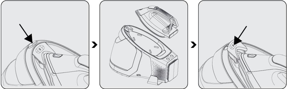
Um das Bügeleisen von der Station zu lösen, drücken Sie auf die Entriegelungstaste der Transportsicherung (14).
