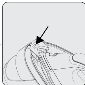
Для отсоединения утюга от док-станции, нажмите кнопку разблокировки замка переноски (14).
