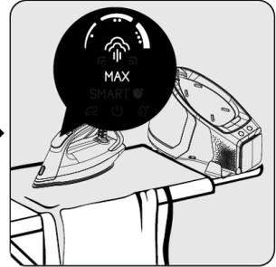
Die LED-Anzeige (1) leuchtet, wenn das Gerät bereit ist, und Sie hören einen Signalton, der anzeigt, dass das Gerät bereit zum Bügeln ist.
