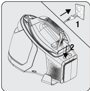
Stecken Sie das Netzkabel ein und drücken Sie den Ein/Aus-Schalter.
