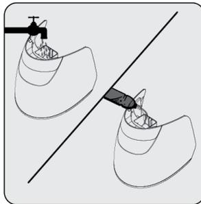
Füllen Sie den Wassertank (11) bis zur Max-Linie auf.
