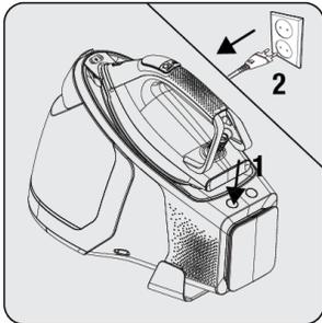
Schalten Sie das Gerät aus und ziehen Sie den Netzstecker, bevor Sie es reinigen.
