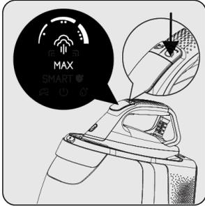
Stellen Sie mit der Dampftaste (3) die für den Stoff geeignete Temperatur und Dampfmenge ein. (siehe 3.6)
