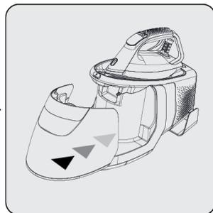
Измните резервуар для воды (11), удерживая его за ручку отсоединения резервуара (13) и оттягивая.
