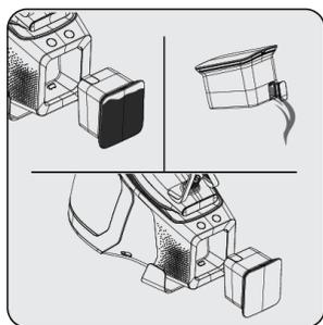
Для опорожнения секции накипи (8), откройте крышку (7) и опорожните. Затем убедитесь, что секция накипи (8) установлена надлежащим образом.
