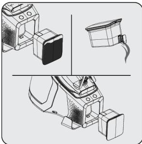
Zum Entleeren des Kalkbehälters (8) öffnen Sie den Deckel (7) und entleeren ihn. Vergewissern Sie sich dann, dass der Kalkbehälter (8) richtig eingesetzt ist.
