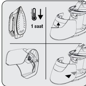
Warten Sie, bis das Gerät vollständig abgekühlt ist. Lassen Sie das restliche Wasser aus dem Wassertank (11) ab.
