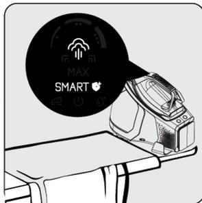
Die LED-Anzeige (1) blinkt, bis das Gerät bereit ist.
