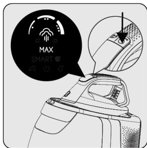
Установите соответствующую ткани температуру и подачу пара с помощью кнопки регулировки уровня (3). (см. раздел 3.6)
