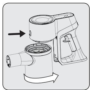
Fixați raccordul de conectare a recipientului de praf la găurile de pe corp, apoi fixați recipientul de praf prin răscucirea în sens invers acelor de ceasornic până când auziți un clic.
