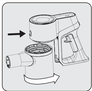
Pričvrstite konektor spremnika za prašinu na rupe na kućištu, zatim pričvrstite spremnik za prašinu okretanjem suprotno od kazaljke na satu dok ne čujete zvuk klika.
