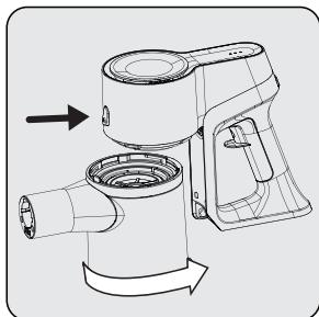
Στερεώστε τον σύνδεσμο του δοχείου σκόνης στις οπές του κυρίως σώματος και κατόπιν στερεώστε το δοχείο σκόνης περιστρέφοντάς το αριστερόστροφα έως ότου ακούσετε τον ήχο κλικ.
