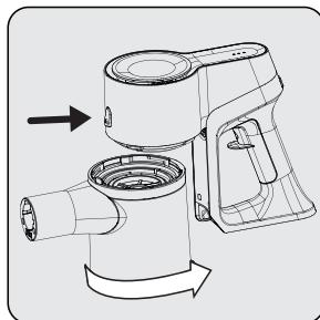
Fije el conector del depósito de polvo a los agujeros del cuerpo, luego fije el depósito girando en el sentido antihorario hasta que escuche el sonido de clic.
