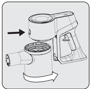
Bevestig de verbinding van de stofcontainer op de openingen van het apparaat. Bevestig daarna de stofcontainer door deze rechtsom te draaien tot u een klik hoort.
