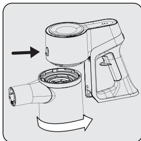
Führen Sie die Zähne des Staubbehälters zu den Löchern am Körper und befestigen Sie den Behälter durch Drehen gegen den Uhrzeigersinn, bis Sie das Klicken hören.
