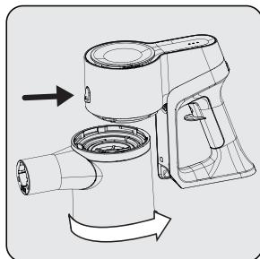
Прикрепите соединитель пылесборника к отверстиям на корпусе, затем закрепите пылесборник, повернув его против часовой стрелки, пока не услышите звук щелчка.
