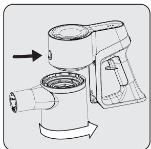
Rögzítse a porgyűjtő csatlakozóját a készülék testén található lyukakhoz, majd rögzítse a porgyűjtőt az óramutató járásával ellentétes irányba forgatva, amíg kattanó hangot nem hall.
