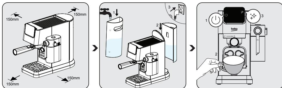
Wählen Sie eine sichere und stabile Oberfläche mit leicht erreichbarer Stromversorgung und lassen Sie einen Mindestabstand von den Seiten der Maschine ein.
