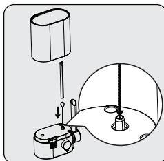
Verwenden Sie die Reinigungsneedle (15), um das Innere des Milchaufschäumers zu reinigen.
