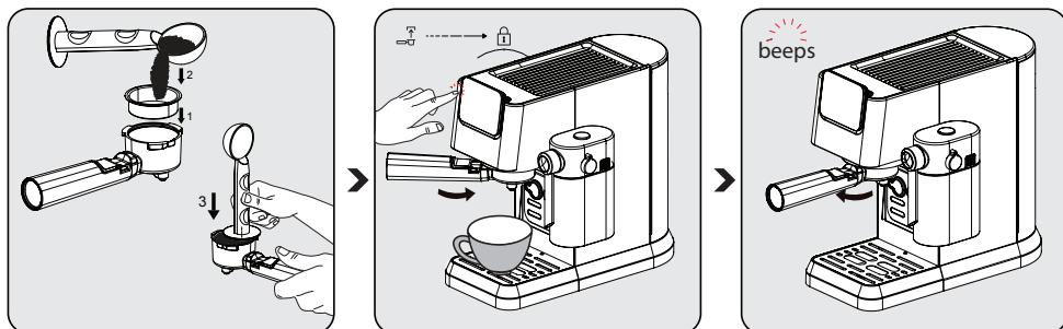
Tek veya çift espresso sepetini filtre tutucunun içine yerleştirin. Bir ölçü kaşığı kullanarak filtreyi taze çekilmiş kahve tozu ile doldurun (yaklaşık 8-15 g) ve fazla tozu düzeltmek için kaşığı kullanın. Tozu eşit ve sıkı bir şekilde bastırmak için kaşığın tokmak ucuya yaklaşık 15 kg uygulayın.
