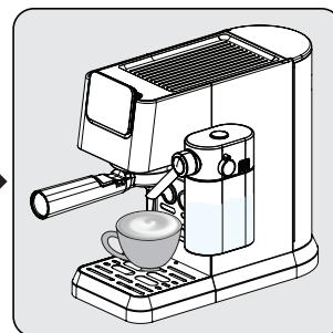
Süt köpüğü bardağa girerken pompa aralıklı olarak çalışır. Süt köpüğü hazır olduğunda, makine otomatik olarak kahveyi pişirmeye başlar.
