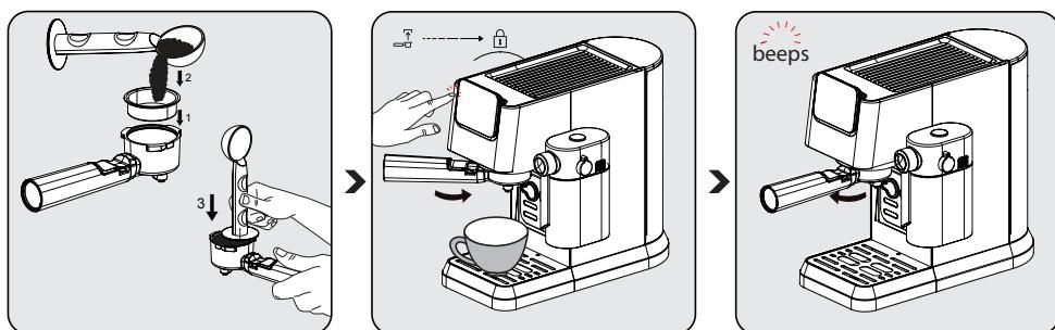
Setzen Sie den einfachen oder doppelten Espressokorb in den Siebträger. Füllen Sie das frisch gemahlene Kaffeepulver mit einem Messlöffel in den Siebträger ein (ca. 8-15 g) und drücken Sie das überschüssige Pulver mit dem Löffel flach. Mit dem Ende des Löffels das Pulver gleichmäßig und fest nach unten zu drücken.
