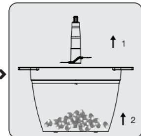
Når bruken er fullført kan du slippe driftsbyrteren. Ta støpselet ut og vent til bladet stanser helt.
