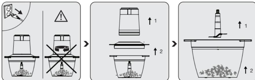
Wenn der Vorgang abgeschlossen ist, hören Sie auf, die Betriebstaste zu drücken. Trennen Sie das Gerät vom Netz und warten Sie, bis das Messer vollständig zum Stillstand gekommen ist.
