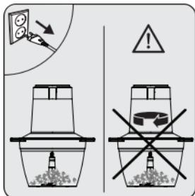
Kun olet valmis, sammuta laite painamalla toimintopainiketta. Irrota laite verkkovirrasta ja odota, kunnes terä on pysähtynyt täysin.
