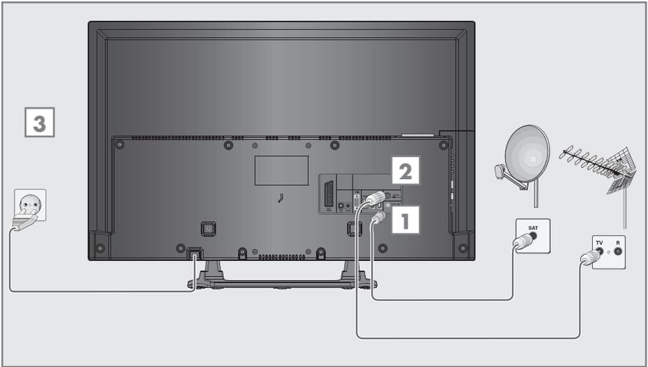
**1** Zum Empfang digitaler Satellitenprogramme (DVB-S/S2) das Kabel der Satellitenantenne an die Antennenbuchse »**SATELLITE**« am Fernsehgerät anschließen.
