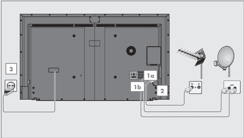
**1a** Zum Empfang digitaler Satellitenprogramme (DVB-S) das Kabel der Satellitenantenne an die Antennenbuchse **SATellite MAIN** am Fernsehgerät anschließen.
