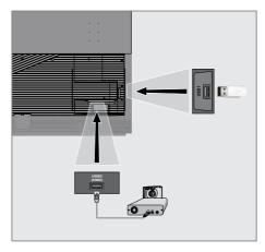
Schließen Sie externe Datenträger (z. B. externe Festplatte, Digitalkamera, Kartenleser oder MP3-Player) über ein USB-Kabel an den USB (HDD)-Anschluss Ihres Fernsehgerätes an.
