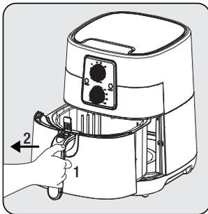
Fassen Sie den abnehmbaren Korbgriff fest an, um die Korbschublade zu öffnen; nehmen Sie dann die Schublade aus dem Gerät heraus und stellen Sie sie auf eine flache und saubere Oberfläche.
