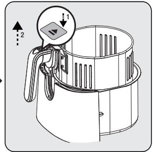
Um den Frittierkorb aus der Schublade zu lösen, stellen Sie die Schublade auf eine flache Oberfläche. Heben Sie die Schutzabdeckung (5) an, drücken Sie den Korbfreigabeknopf (6) und heben Sie den Frittierkorb aus der Schublade.
