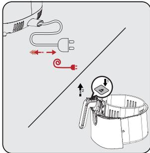
Um das Netzkabel (11) zu verstauen, schieben Sie dieses in den Aufbewahrungsbereich. Drücken Sie den Korb Freigabeknopf (6) und entfernen Sie den Frittierkorb (9), indem Sie den Griff (7) anheben und nach oben ziehen.
