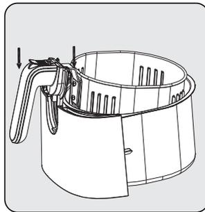
Es gibt 2 Kerben auf beiden Seiten des Griffs. Verriegeln Sie den Frittierkorb in der Schublade, indem Sie die Laschen in die Aussparungen an der Oberseite der Korbschublade schieben.
