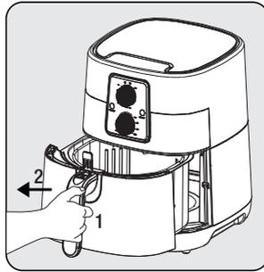
Fassen Sie den abnehmbaren Korbgriff (7) fest an, um die Korbschublade zu öffnen; nehmen Sie dann die Schublade aus dem Gerät heraus.
