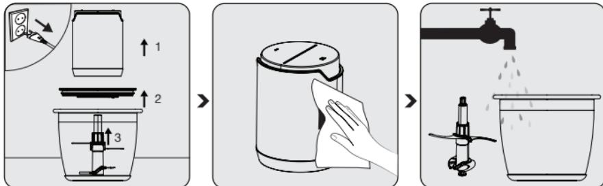
Iskopčajte uređaj iz strujne mreže. Uklonite jedinicu motora (4), poklopac (3), a zatim oštice (6).
