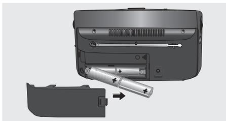
2 Vier Batterien (4 x 1,5V, Typ IEC, AM 2, LR 14, C-Size) einsetzen, dabei die im Batteriefach markierte Polung beachten.
