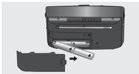
2 Insérez quatre batteries (4 x 1.5V, Type IEC, AM 2, LR 14, taille C) conformément à la polarité indiquée sur le compartiment des piles.
