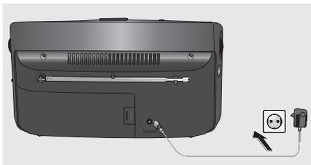
2 Stecker des Netzkabels in die Steckdose (100-240V~, 50/60 Hz) stecken.
