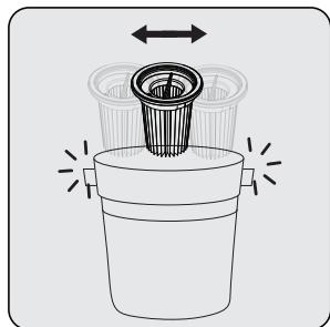
Entfernen Sie den Staub vom EPA E10-Filter, indem Sie ihn auf eine harte Oberfläche wie einen Abfallbehälter klopfen oder eine Bürste verwenden.
