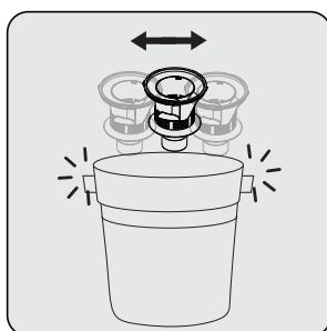
Entfernen Sie den Staub aus dem Kunststofffilter, indem Sie ihn auf eine harte Oberfläche wie einen Abfallbehälter klopfen oder eine Bürste verwenden.
