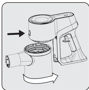
Připevněte konektor nádoby na prach do otvorů na tělese a poté upevněte nádobu na prach.
