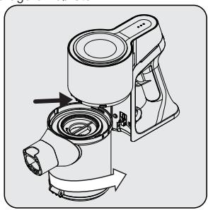
Sæt støvbeholderens tænder i hullerne på kroppen, fastgør derefter beholderen ved at dreje mod uret indtil du hører en kliklyd.
