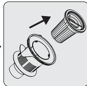
Odvjmite filter EPA E10 i plastični filter.
