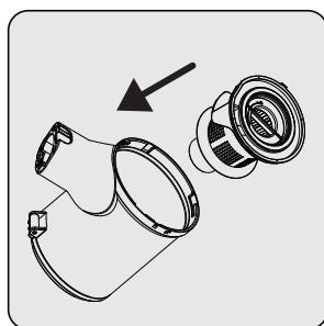
Kiinnitä muovisuodatin pölysäiliöön (5).
