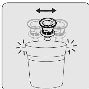
Удалите пыль с пластикового фильтра, постучав им о твердую поверхность, например мусорный бак, или используя щетку.
