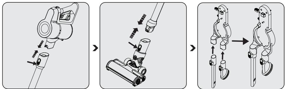
Štapni dio (10) gurnite u smjeru prema kućištu guranjem gumba za odvajanje štapnog dijela (6).
