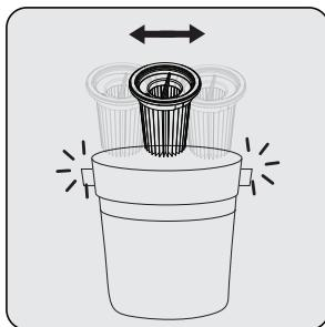
Retirez la poussière du filtre EPA E10 en le frappant délicatement contre une surface dure telle qu'une poubelle ou à l'aide d'une brosse ou d'un aspirateur.
