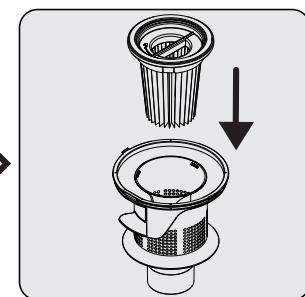
Kiinnitä EPA E10 suodatin muovisuodattimen takaosaan.
