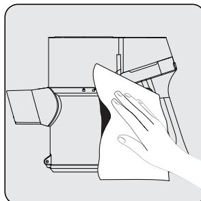
Tørk av hoveddelens overflaten med en våt klut.
