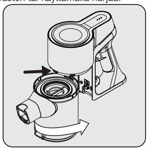
Työnnä pölysuodattimen hampaat reikiin rungossa ja kiinnitä säiliö kiertämällä sitä vastapäivään, kunnes kuulet napsahduksen.
