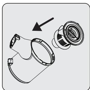
Befestigen Sie den Kunststofffilter am Staubbehälter (5).
