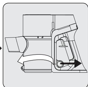
Pour un nettoyage en profondeur des filtres, retirez le corps du réservoir à poussière en le tournant dans le sens des aiguilles d'une montre tout en tirant légèrement sur l'anneau du réservoir à poussière (4).
