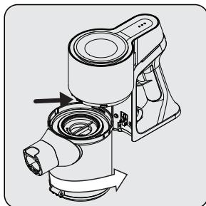
Прикрепите соединитель пылесборника к отверстиям на корпусе, затем закрепите пылесборник, повернув его против часовой стрелки не услышите звук щелчка.
