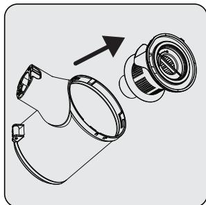
Povucite filter EPA E10 i plastični filter držeći ručku filtra EPA E10.
