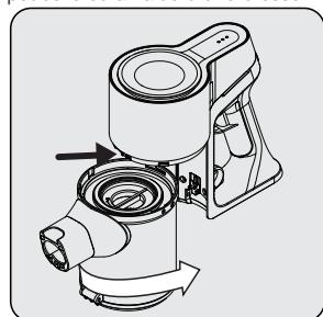
Passez les dents du réservoir à poussière dans les trous du corps, puis fixez le réservoir en le tournant dans le sens inverse des aiguilles d'une montre jusqu'à ce que vous entendiez un clic.
