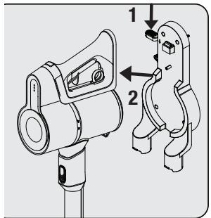
1- Paina laitteen vapautuskytkintää (7) latausasemassa (8) ja vedä laitetta itseäsi päin samalla.
