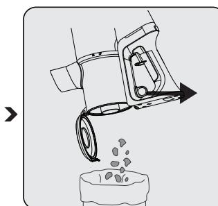
Tirez l'anneau d'ouverture du réservoir à poussière (4) jusqu'au dernier niveau. Le couvercle du réservoir à poussière s'ouvre. Videz toute la poussière qu'il contient.
