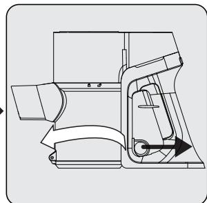
For en detaljeret rengøring af filtre, fjern støvbeholderens krop ved at dreje den med uret mens du trækker let i støvbeholderens ring (4).
