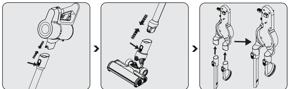
Poussez le tube (10) dans le sens de la flèche vers le corps en appuyant sur le bouton de déverrouillage du tube (6).
