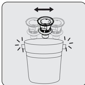
Ta bort damm från plastfiltret genom att slå den mot en hård yta, såsom skräpkorg eller använd borste.
