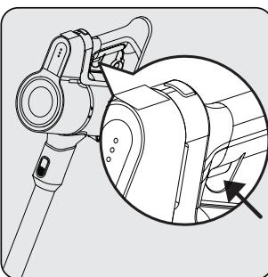
Drücken Sie den Ein-/Aus-Schalter (3), um das Gerät zu bedienen. Das Gerät beginnt auf der niedrigsten Stufe zu laufen, wenn der Ein-/Aus-Schalter gedrückt wird.
