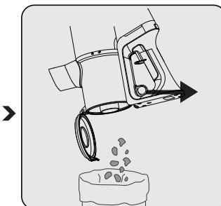
Dra dammbehållarens lockets öppningsring (4) helt ut. Dammbehållarens lock öppnas. Töm behållaren helt.
