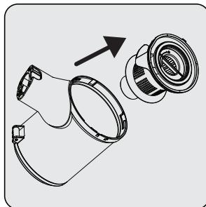
Вытяните EPA E10 и держатель пластикового фильтра из ручки EPA E10.
