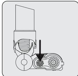
Pritisnite gumb za odvajanje okretne četke.
