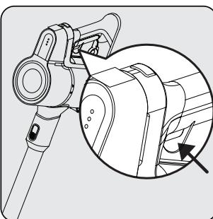
Appuyez sur le commutateur Marche/Arrêt (3) pour faire fonctionner l'appareil. L'appareil fonctionne à la vitesse minimale lorsque vous appuyez sur le commutateur Marche/Arrêt.
