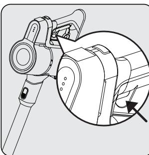
Pritisnite prekidač uključeno/isključeno (3) za rukovanje uređajem. Uredaj počinje s radom s minimalnom brzinom kada se pritisne prekidač uključivanja/isključivanja.
