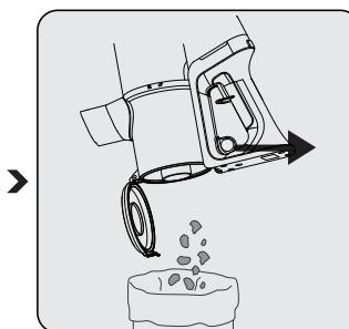
Povučite prsten za otvaranje poklopca spremnika za prašinu (4) do zadnje točke. Otvorit će se poklopac spremnika za prašinu. Ispraznite svu prašinu iz spremnika.
