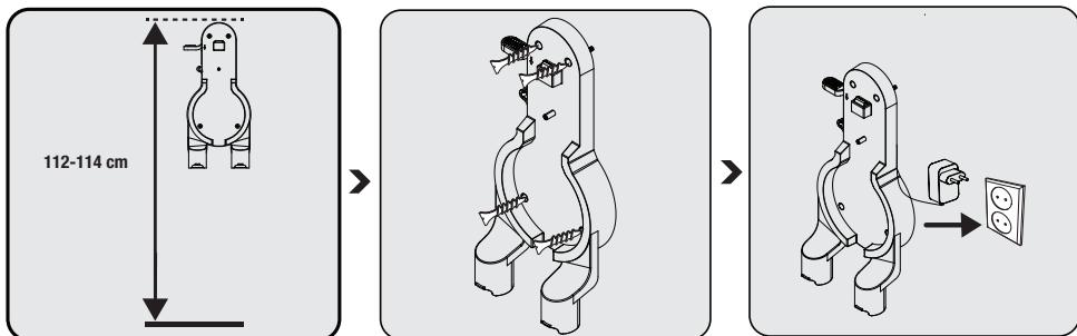
Placer opladningsenheden (8) i en højde på 112- 114 cm fra gulvet.
