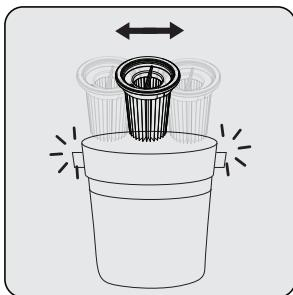
Ta bort damm från EPA E10 filtret genom att slå den mot en hård yta, såsom skräpkorg eller använd borste.
