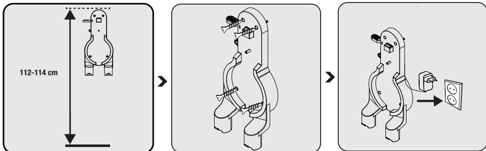
Positionnez la station de charge (8) à une hauteur de 112 à 114 cm du sol.
