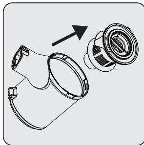
Vedä EPA E10 ja muovinen suodattimen pidike irti EPA E10 kahvasta.
