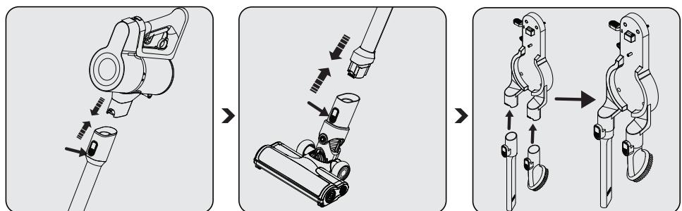
Stecken Sie das Saugrohr an das Ende des Gehäuses.
