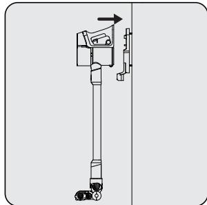
Aseta laite latausasemaan (8). Kun pölysäiliö (5) on asennettu latausasemaan (8), työnnä laitetta latausasemaa päin.
