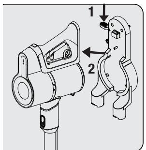
1- Poussez le bouton de déverrouillage de l'appareil (7) sur la station de charge (8) vers le bas et tirez en même temps l'appareil vers vous.
