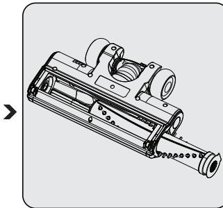
Retirez-en la poussière en la frappant légèrement contre une surface dure ou à l'aide d'une brosse. Si des poils ou d'autres objets sont coincés dessus, retirez-les en les coupant.
