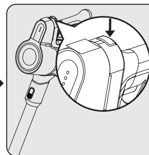
Za prebacivanja na maksimalnu brzinu tijekom rada pri minimalnoj brzini pritisnite gumb podešavanja brzine (2). Za prebacivanja na minimalnu brzinu tijekom rada pri maksimalnoj brzini pritisnite gumb podešavanja brzine (2).
