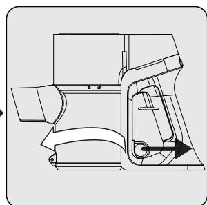
Za detaljno čišćenje filtara, uklonite kućište spremnika za prašinu okretanjem u smjeru obrnutom od smjera kazaljke na satu dok lagano povlačite prsten spremnika za prašinu (4).
