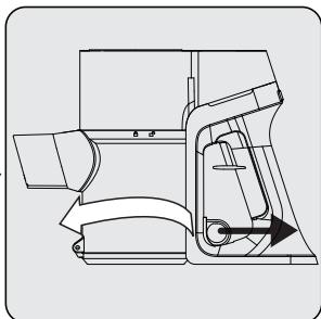
For detaljert rengjøring av filter, fjern støvbeholderhuset ved å vri det mot klokken mens du trekker lett i støvbehoderringen (4).
