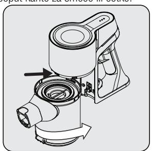
Zupce spremnika za prašinu gurnite u otvore na kućištu, zatim pričvrstite spremnik okretanjem u smjeru kazaljke na satu dok ne čujete zvuk „klik“.
