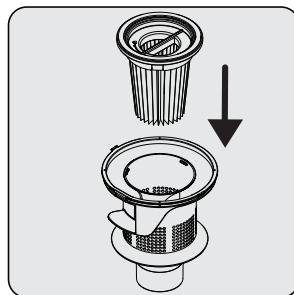
Fäst EPA E10 filtret i plastfiltern.
