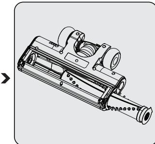
Uklonite prašinu s nje laganim lupkanjem o tvrdou površinu ili prašinu uklonite četkom. Ako su se zapetljale dlake, odrežite ih.
