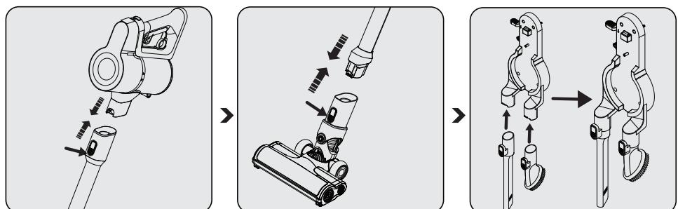
Boruyu (10) borunun üzerinde bulunan boru çıkışma düğmesine (6) basarak gövdeye doğru ok yönünde itin.
