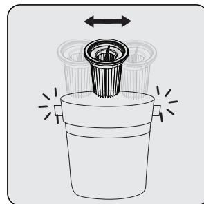
Fjern støvet på EPA E10-filteret ved at slå dem mod en hård overflade, som en skraldespand eller ved at bruge en børste.
