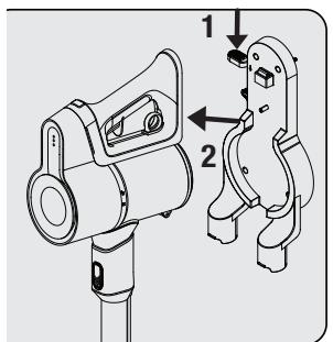
1- Drücken Sie die Geräte - Entriegelungstaste (7) an der Wandhalterung (8) nach unten und ziehen Sie das Gerät gleichzeitig zu sich hin.
