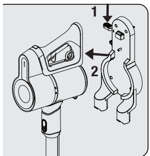
1- Gurnite gumb za otpuštanje uređaja (7) na stanicu za punjenje (8) prema dolje, a istovremeno povucite uređaj prema sebi.
