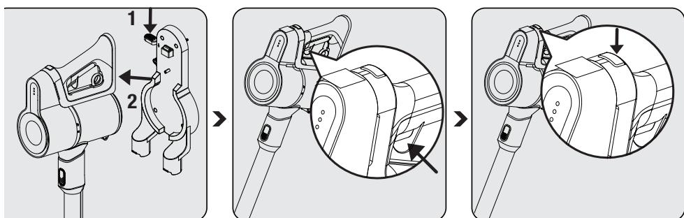
1-Sarj istasyonu (8) üzerindeki cihazı çıkarma tetiğine (7) aşağı yönlü itin ve aynı anda cihazı kendinize doğru çekin.
