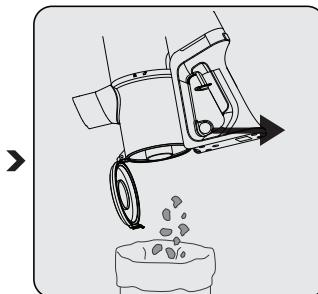
Trekk åpningsringen til støvbeholderlokket (4) til siste punkt. Støvbeholderlokket åpnes. Tøm alt støvet det inneholder.
