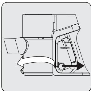
Suodattimien puhdistamiseksi, irrota pölyssäiliön runko kiertämällä sitä myötäpäivään ja vetämällä pölyssäiliön rengasta (4) kevyesti.
