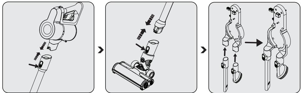
Tryck skaftet (10) i pilens riktning mot kroppen genom att trycka på skaftets öppningsknapp (6).
