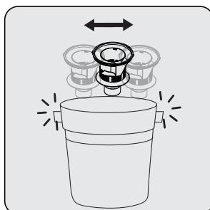
Fjern støvet på plastikfilteret ved at slå dem mod en hård overflade, som en skraldespand eller ved at bruge en børste.
