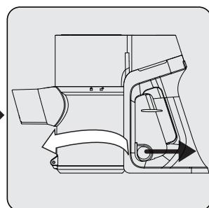
Для тщательной очистки фильтров снимите пылесборник, повернув его по часовой стрелке потянув за кольцо пылесборника (4).
