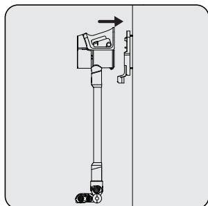
Поместите прибор на зарядную док-станцию (8). Поместив пылесборник (5) на зарядную док-станцию (8), подтолкните устройство к зарядной док-станции.
