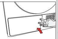
Asenna ilmansiirtoluukku paikalleen sulkemalla salvat ja sulje jalkalevy puhdistuksen jälkeen.
