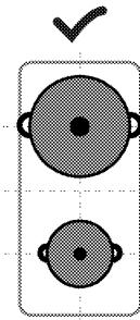
Las zonas de cocción de superficie ancha cuentan con dos zonas de cocción, como la delantera y la trasera. Puede utilizar estas zonas como dos zonas independientes de cocción para diferentes niveles de temperatura con dos ollas/sartenes diferentes. Ponga las ollas/sartenes centrando las zonas de cocción separadas.
