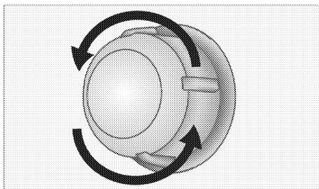
3. Si la lampe du four est de type (A) illustré dans la figure ci-dessous, tournez la lampe du four comme indiqué dans la figure et remplacez-la par une nouvelle. Si le type (B) est un modèle, retirez-la comme indiqué dans la figure et remplacez-la par une nouvelle.
