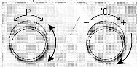
**i** Si vous changez la fonction de cuisson après la modification de la température prédéfinie pour les fonctions de cuisson, la dernière température réglée s'affiche à l'écran. Cependant, si la température réglée ne se situe pas dans la plage de température de la fonction de cuisson sélectionnée, la température réglable la plus élevée de cette fonction de cuisson s'affiche.
