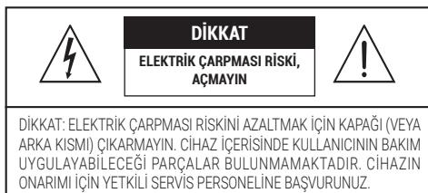
**⚠ Eş kenarlı üçgen içinde şimşek şeklindeki ok ucu simgesi, ürün kasası içerisinde elektrik çarpması riski oluşturabilecek yeterli ölçüde gerilime sahip yalıtmışız "tehlikeli voltajın" bulunduğu konusunda kullanıcıları uyarmak amacıyla kullanılmaktadır.**
