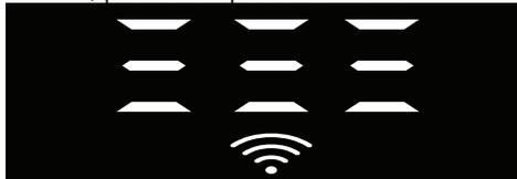
Se la connessione wireless è abilitata, l'indicatore di connessione Wi-Fi è sempre acceso; se la connessione wireless è disattivata, la spia di connessione Wi-Fi lampeggia a brevi intervalli.
