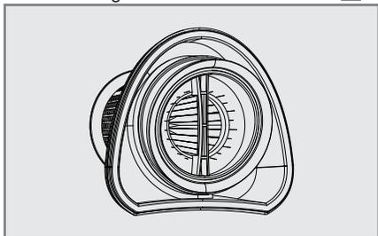
3 HEPA-filteret tas ut ved å holde i håndtaket på filterholderen og dreie det mot urviseren.
