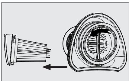
4 Umyj pojemnik na kurz **I**, obudowę filtra i filtr HEPA pod bieżącą wodą.
