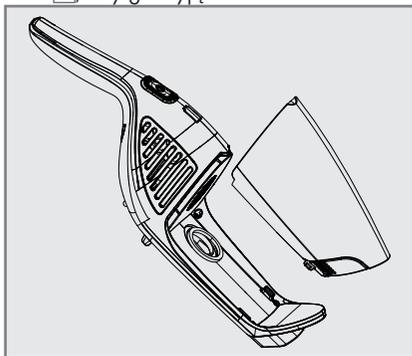
2 Wyciągnij filtr z obudowy, trzymając za uchwyt, i wyjmij go z pojemnika na kurz **I**.
