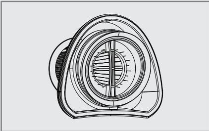
3 Entfernen Sie den EPA-Filter durch Greifen des Griffs am Filterhalter und durch Drehen gegen den Uhrzeigersinn.
