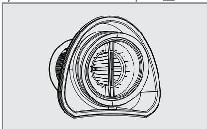
3 Retire el filtro HEPA sujetando el asa del soporte del filtro y girándola en el sentido contrario a las agujas del reloj.
