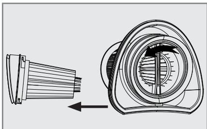
4 Tvätta dammbehållaren **I**, filterhållaren och HEPA-filtret i under rinnande vatten.
