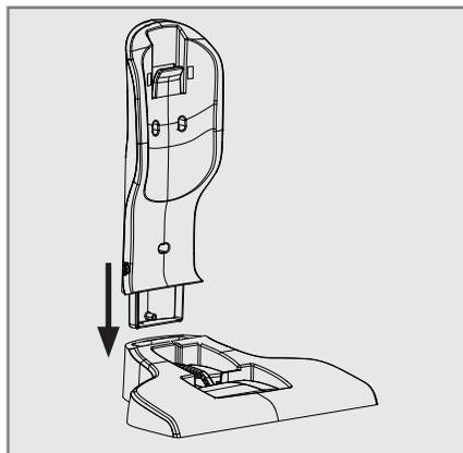
2 Brug skruer til at montere enheden på væggen, eller placer den på en vandret flade.
