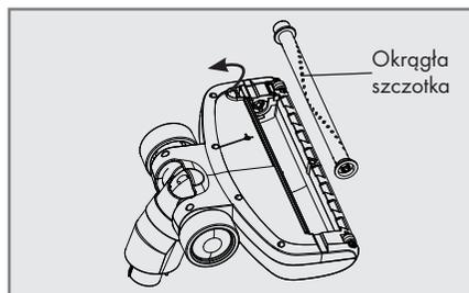
2 Po umyciu i wysuszeniu okrągłej szczotki, zamontuj ją ponownie i zablokuj klapkę.
