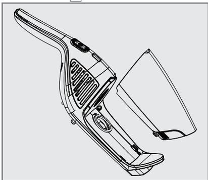
2 Trekk filteret ut av holderen ved å holde på håndtaket og ta det ut av støvkammeret **I**.
