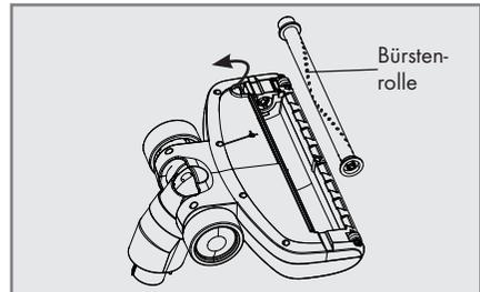
2 Nach Reinigung und Trocknung der Bürstenrolle diese wieder anbringen und den Riegel sperren.
