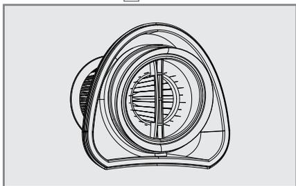
3 Ta bort HEPA-filtret genom att ta tag i filterhållarens handtag och vrid moturs.
