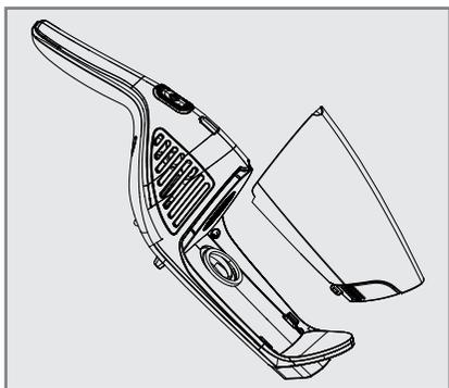
2 Dra ut filtret från hållaren genom att hålla i handtaget och ta bort det från dammbehållaren **I**.
