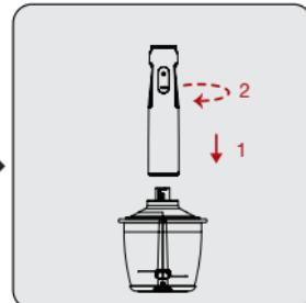
Setzen Sie die Motoreinheit (4) auf den Deckel (6).
