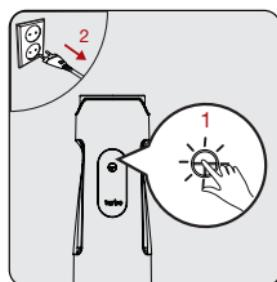
Kada se postupak završi, puštite gumb uključivanja/isključivanja (2). Iskopčajte uređaj iz strujne mreže.
