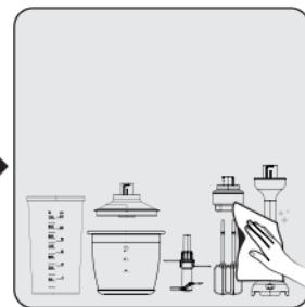
Prije čišćenja isključite uređaj. Pripazite jesu li se svi dijelovi uređaja potpuno zaustavili. Jedinicu motora (4) obrišite vlažnom krpom.
