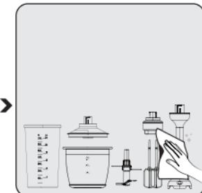
Înainte de curățare scoateți aparatul din priză. Asigurați-vă că toate componentele mobile ale aparatului s-au oprit în totalitate. Ștergeți cu o cârpă umedă unitatea motorizată (4) a aparatului.
