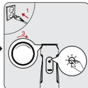
Băgați aparatul în priză. Apăsați butonul pornire/oprire (2) și începeți utilizarea. Apoi ajustați viteza prin rotirea butonului de reglare a vitezei (1).
