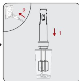
Stavite sastojke koje želite obraditi u posudu mjerici (10) ili sličnu zdjelu i ukopčajte uređaj u strujnu utičnicu.
