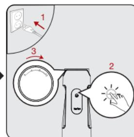
Aparat ukopčajte u struju utičnicu. Pritisnite gumb uključivanje/isključivanje (2) i rukujte uređajem. Zatim prilagodite brzinu okretanjem gumba podešavanja brzine (1).
