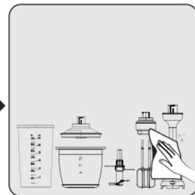
Αποσυνδέστε τη συσκευή από το ρεύμα πριν τον καθαρισμό της. Βεβαιωθείτε ότι όλα τα μέρη της συσκευής έχουν σταματήσει τελείως να κινούνται. Σκουπίστε τη μονάδα μοτέρ (4) της συσκευής με ένα ελαφρά υγρό πανί.
