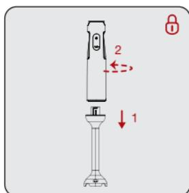
Pričvrstite štapni mikser (12) na jedinicu motora (4) okretanjem kraja jedinice motora (4) "1" u smjeru suprotnom od smjera kazaljke sata.
