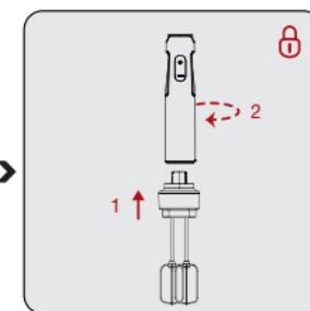
Pričvrstite držač mutilica (7) na jedinicu motora (4) okretanjem u smjeru obrnutom od smjera kazaljke na satu “”.
