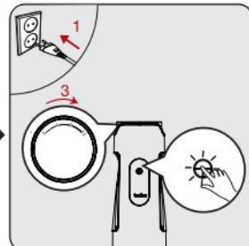
Schließen Sie das Gerät an. Drücken Sie die Power-Taste (2) und nehmen Sie es in Betrieb. Stellen Sie dann die Geschwindigkeit durch Drehen des Geschwindigkeitsreglers (1) ein.
