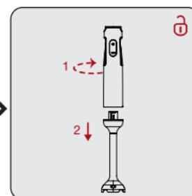
Okrenite štapni mikser (12) u smjeru kazaljke sata "1" i odspojite ga od jedinice motora (4).
