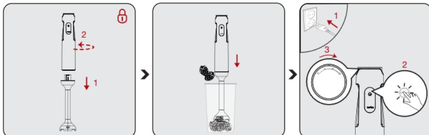
Установите вал блендера (12) на блок электродвигателя (4), повернув конец блока (4) “” против часовой стрелки.
