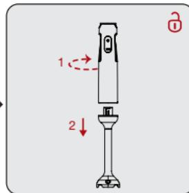
Поверните погружную часть (12) по часовой стрелке, “⊕”, чтобы отсоединить его от блока двигателя (4).
