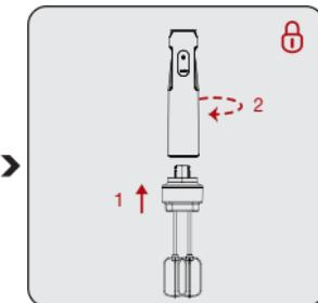
Установите держатель венчиков (7) на электродвигатель (4), повернув по часовой стрелке “ $\Theta$ ”/
