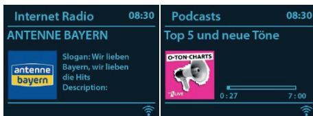
L'appareil peut jouer des milliers de stations de radio et des podcasts du monde entier grâce à une connexion Internet à haut débit. Lorsque vous sélectionnez le mode radio Internet ou Podcasts, l'appareil contacte directement le portail Frontier Smart Technologies pour obtenir une liste de stations ou de podcasts.
