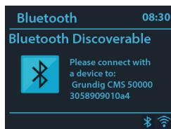
En mode Bluetooth, vous pouvez activer le Bluetooth de votre appareil Bluetooth. Appuyez et maintenez »**BTPAIR**« afin de rendre le Bluetooth détectable. À partir de votre appareil Bluetooth, recherchez le système HiFi Grundig CMS 5000 à l'appariement. Lorsqu'il est en attente d'appariement, il y a une icône Bluetooth clignotante en bas. Si l'appariement a réussi, l'icône Bluetooth devient fixe. Contrôlez la lecture de la musique à partir de votre appareil Bluetooth.
