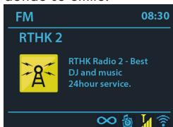
La primera vez que seleccione el modo de radio FM, o si la lista de estaciones está vacía, el dispositivo ejecutará la búsqueda automática y guardará las estaciones en la lista de preajustes. Para encontrar una estación, pulse »OK/SCAN«. La pantalla de frecuencia comienza a funcionar a medida que el dispositivo escanea la banda FM. Alternativamente, puede escanear hacia arriba o hacia abajo girando la perilla de navegación.
