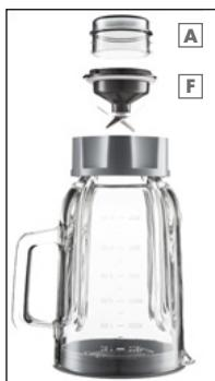
4 Coloque la taza de medir **A** en los asientos de la unidad de cuchillas **F**.
