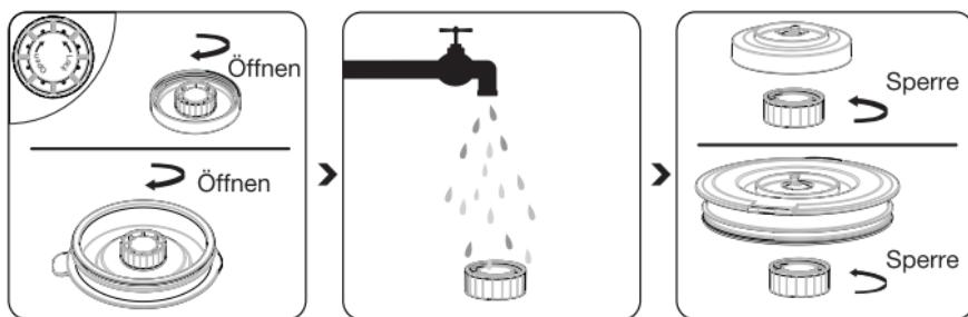
Drehen Sie den Deckel (C, B) um und öffnen Sie die Rücklaufschutzkappe, indem Sie diese zum Entfernen vom Deckel (C, B) gegen den Uhrzeigersinn drehen.
