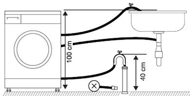
4. Damit kein verschmutztes Wasser in das Produkt zurücklaufen kann und um der Maschine das Abpumpen zu erleichtern, darf das Ende des Schlauches nur maximal 15 cm tief in den Ablauf eingeführt werden.
